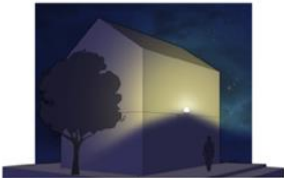
Éclairage très mauvais : une grande partie du flux lumineux est perdue dans le ciel avec pour conséquences un gaspillage d'énergie et une pollution lumineuse très importante.
