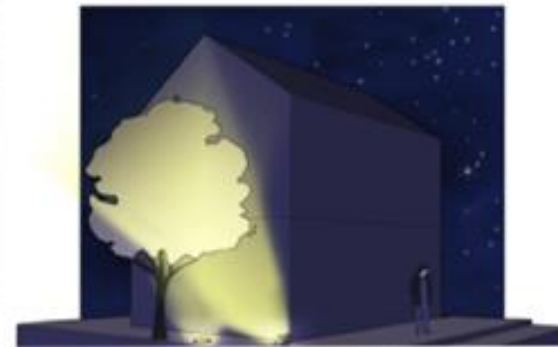
Éclairage très mauvais : le flux est dirigé du bas vers le haut et éclaire la végétation. Il y a une forte nuisance sur la végétation et la faune hébergée ainsi qu'une forte pollution lumineuse
