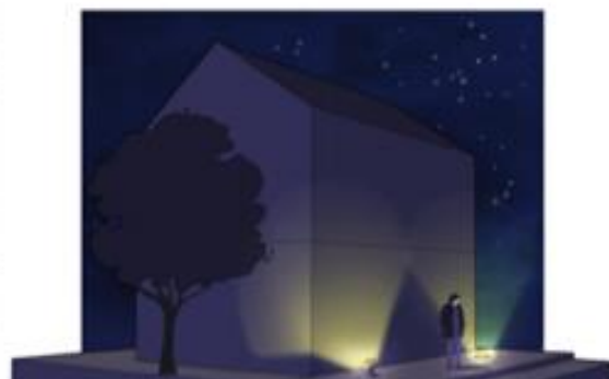
Éclairage mauvais : le flux est dirigé du bas vers le haut avec de fortes déperditions et une forte pollution lumineuse.
