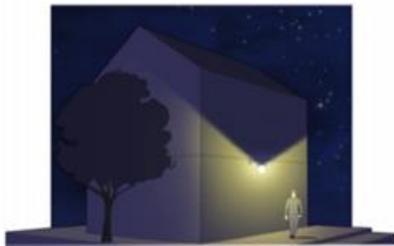
Éclairage moyen : le flux est majoritairement dirigé vers le bas mais une partie importante de celui-ci dépasse le plan horizontal. La pollution lumineuse est importante.
